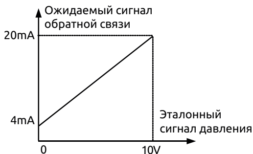
Рис. 7-38 Эталонный и ожидаемый сигнал обратной связи
