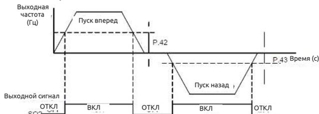
**Примечание:** В этом разделе SU, FU - это названия функций для “клеммы универсального цифрового выхода” SO1, SO2. Смотрите описания параметров 03-10 ~ 03-13. Соответствующая электропроводка описана в разделе 3.5.
