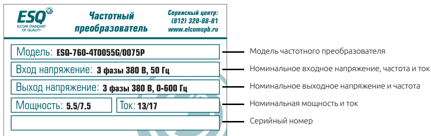
Рисунок 2-4. Изображение шильды частотного преобразователя ESQ-760
